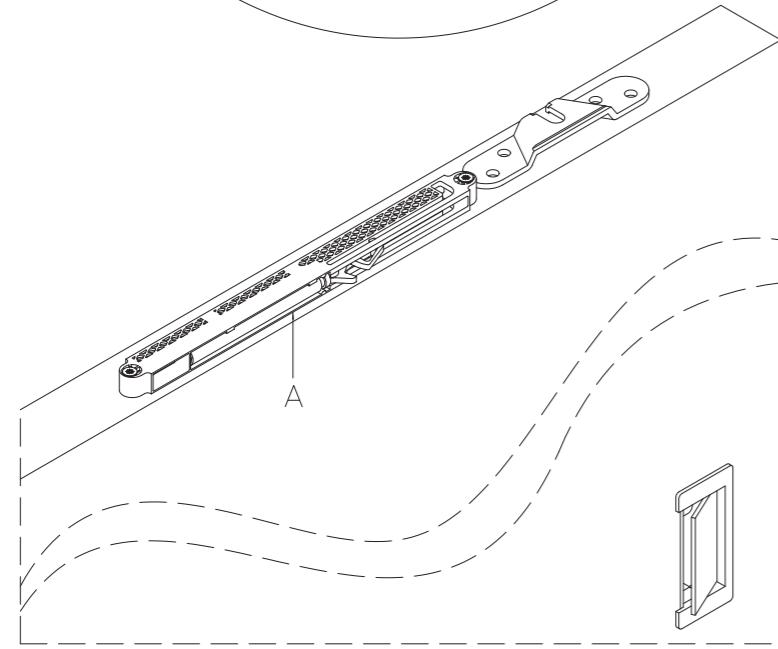
Fixer le système de fermeture "A" à la porte selon les dimensions indiquées. Utiliser les vis fournies "A1" TSP Ø3,5X40 DIN7505-A. Fixer avant le système de fermeture "A" (phase 1) et ensuite l'étrier du chariot « F » (phase 2).
