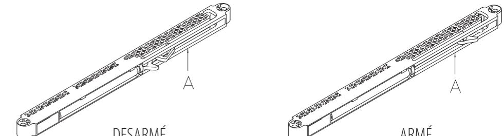
Installer le panneau, le placer en position "fermer" et ajuster le réglage si nécessaire en dévissant les vis de l'arrêtoir "B1" pour l'ajuster de quelques millimètres. Vérification finale: ouvrir la porte et désarmer le système de fermeture "A". Ensuite fermer la porte en vérifiant le correct accrochage entre "A" et "B".
