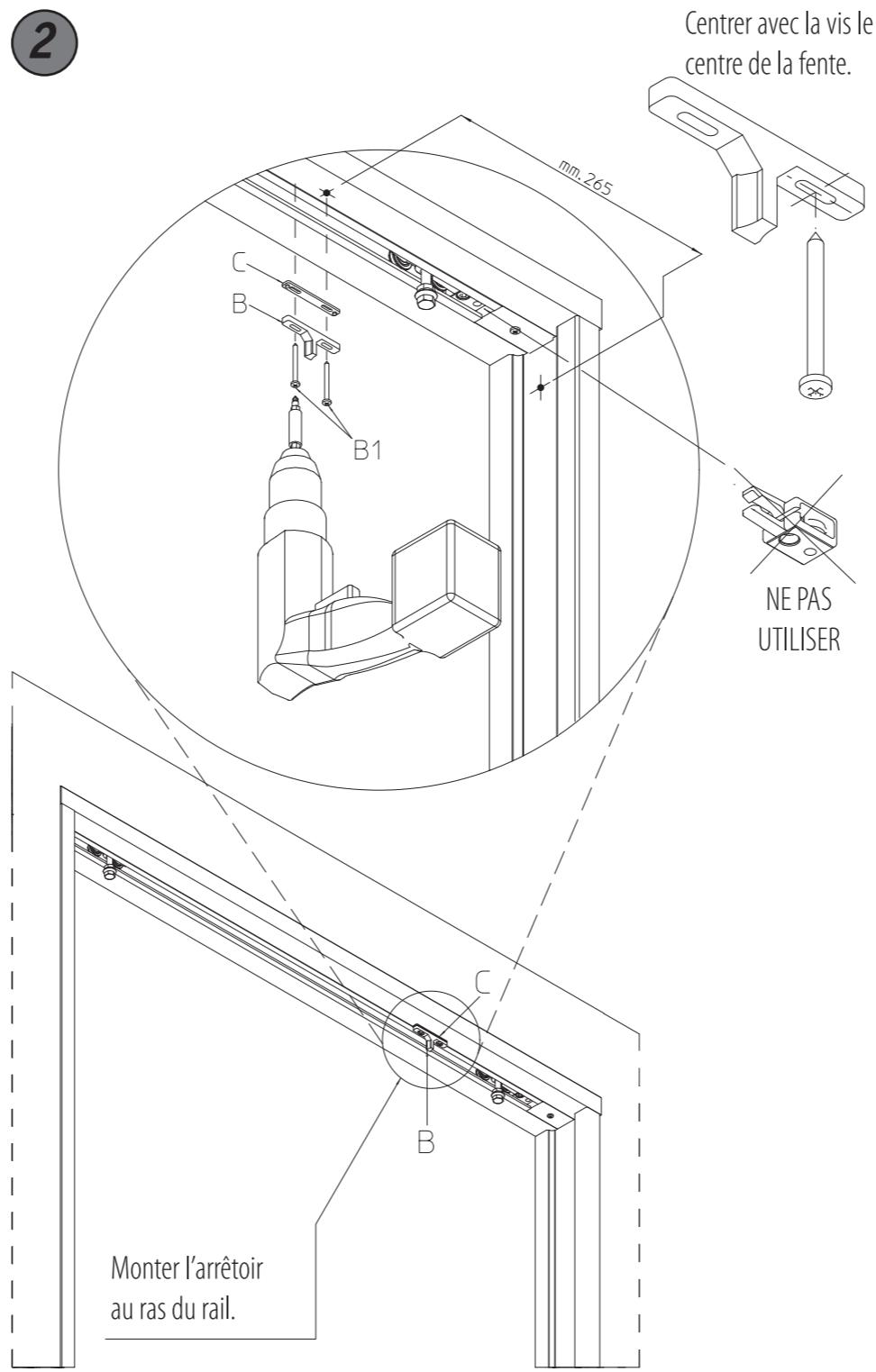
Fixer l'arrêtoir "B" en l'associant à la platine "C" sur la traverse. Utiliser les vis fournies "B1" TC Ø3,5x40 DIN7505-B. Pour son positionnement respecter les dimensions indiquées. Ajouter ou retirer les platines "C" fournies afin d'obtenir l'accouplement parfait de l'arrêtoir "B" avec le système de fermeture "A".
